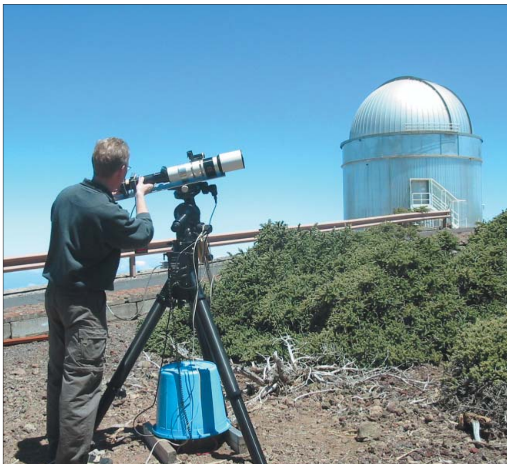
Vores test-instrument testes ved det Nordiske Optiske Teleskop (kuplen bagved) på La Palma, maj 2004. Det automatiske teleskop (i forgrunden) er en 12 cm refraktor med 600 mm brændvidde.
