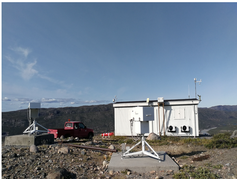
Fig. 1.1: Observatorium i Kangerlussuaq, som deles med EuMetSat. På billedet ses i forgrunden Brewer-spektrometre, ved tagkanten på hylden ses SAOZ-spektrometeret, mens AeroNet-robotten ses til højre på taget.
