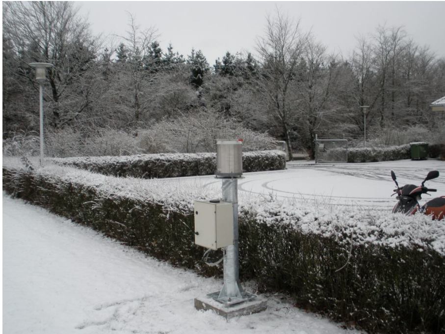
Billede 5: Komplet nedbørstation med GPRS styreskab
