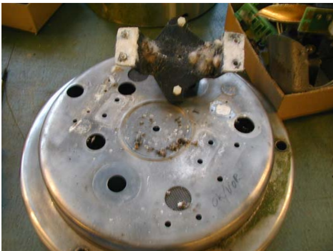
Billede 2: Bunden af Rimco måleren før renovering
