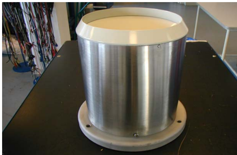
Billede 4: Samlet nedbørmåler efter reovering
