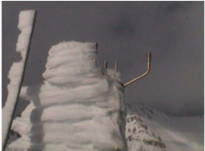
Figur 8. Sonisk anemometer af den type, som DMI anvender, med kraftig ispålejring.
