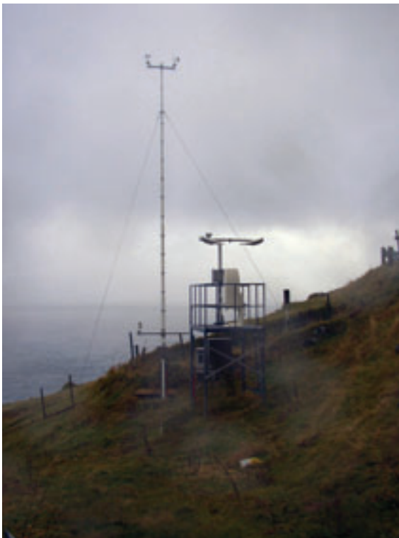
Figur 3. DMI's automatiske vejrstation (V98) ved Kirkja, Fugloy, Færøerne. Stationsnr.: 06012. Bemærk at placeringen ikke er helt ideel på et skrånende underlag.
