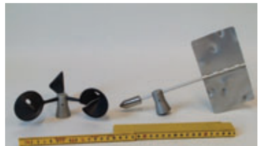
Figur 4b. Selv om vindmåleinstrumenterne er konstrueret af stærke materialer, kan ulykker ikke undgås: her har "spøgefugle" skudt til måls efter vindmålerne med en salonriffel eller et kraftigt luftgevær. Det er således ikke kun skarver som laver "sjov" med vindmålingerne!
