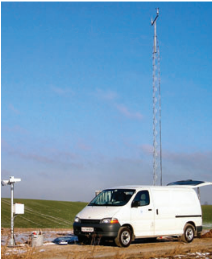
Figur 1. DMI's automatiske vejrstation med vindmast ved Brandelev. Stationsnr.: 06154. Vejrstationen ved Brandelev er en såkaldt V98-station og vindmålingerne foretages med et opvarmet kopanemometer og en opvarmet vindfane begge af fabrikatet Vaisala.
