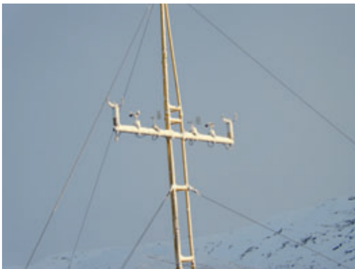
Figur 7. Sonisk anemometer testmast med andre vindinstrumenter. Denne vindtestmast står på en DMI-teststation i Narsarsuaq, SV-Grønland. På de to soniske anemometre (længst fra masten til hver side) er det kun sender/modtager-enhederne (for enden af armene) der er opvarmet mens hverken armene eller instrumenthuset er opvarmet med en uhensigtsmæssig snepålejrning til følge. Selvom opvarmningen af sensorhovederne, som det fremgår af billedet, er det ikke muligt helt at forhindre snepålejrning, hvorfor det i det viste tilfælde er nødvendigt at opjustere opvarmningen.
