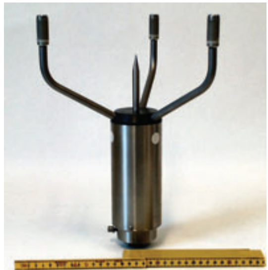
Figur 6. Sonisk anemometer fra firmaet Vaisala som kan måle vindhastighed i de to horisontale retninger samt vindretning. På åbne lokaliteter, hvor vindmasterne typisk er placerede, kan det soniske anemometer på mange fuglearter virke som en oplagt sidde/hvile-plads, hvilket også er blevet observeret i felten. F.eks hvis skarver får for vane at benytte pladsen mellem transducerne som siddeplads, vil det resultere i at en stor procentandel af vindmålingerne blive ubrugelige. For at undgå dette problem har DMI teknisk sektion videreudviklet det oprindelige instrument med en centralt placeret metal-spids som forhindre fugle i at sætte sig på instrumentet.
