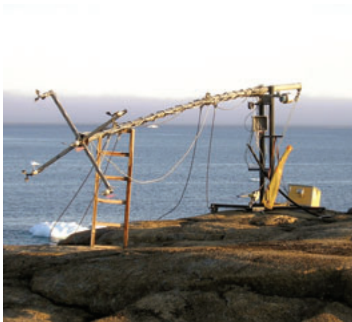
Figur 2. DMI’s automatiske vejrstation ved Aputiteek. Stationsnr.: 04351. Stationen ved Aputiteek er en af DMI’s såkaldte ødestationer, hvor der i dublet måles de 5 meteorologiske standardparametre dvs. lufttemperatur, luftfugtighed, lufttryk, vindhastighed og vindretning. Masten er lagt ned i forbindelse med det rutinemæssige serviceeftersyn.
