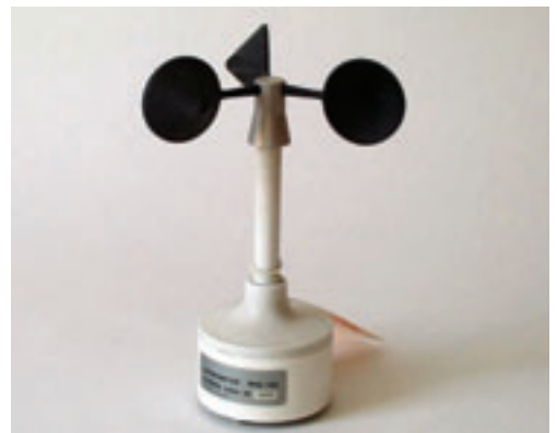
Figur 4a. Kopanemometer med kopper konstrueret af kulfiber for at gøre det så let og stærkt som muligt.
